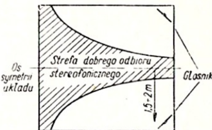
Rys. 4. Rozmieszczenie głośników zestawu w małym pokoju mieszkalnym
