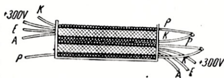
Rys. 4. Rozmieszczenie uzwojeń transformatora Tr1
