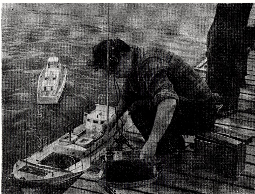
Fot. 2. Widok modelu i nadajnika z manipulatorem i zasilaczem
