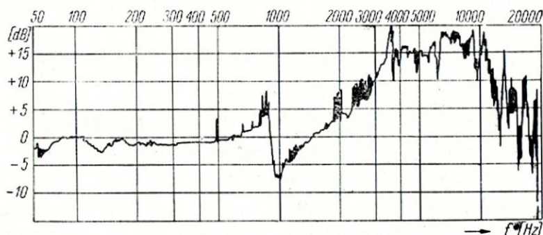
Rys. 8. Hypsogram częstotliwościowej charakterystyki skuteczności mikrofonu krystalicznego RFT
