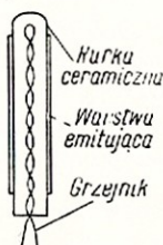
Rys. 1. Katoda lampy pośrednio żarzonej (w przekroju)
