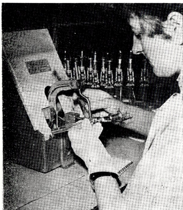
Złutowywanie wyrzutni kineskopu
