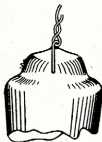
Rys. 1. Naprawa wyprowadzenia siatki
