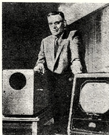
Rys. 1. Ogólny widok Lumiconu; z lewej — kamera, z prawej — odbiornik
