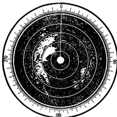
Rys. 16. Ekran radaru ze skalą i kołami odległościowymi
