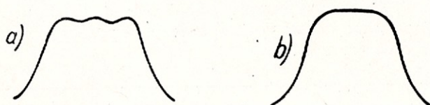
Rys. 3. Przebiegi charakterystyk wzmacniacza z obwodami rozstrojonymi
