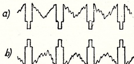
Rys. 10a i b. Dwa rodzaje polaryzacji zespolonego sygnału telewizyjnego.
