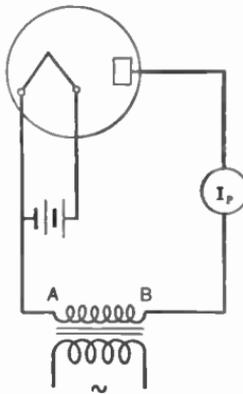
FIG. 237.—Fundamental rectifier circuit.
