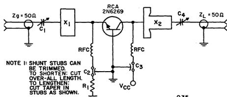
NOTE I: SHUNT STUBS CAN BE TRIMMED TO SHORTEN; CUT OVER-ALL LENGTH. TO LENGTHEN; CUT TAPER IN STUBS AS SHOWN.
