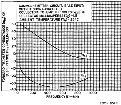
Fig. 11 - Forward transmittance ( $y_{fe}$ ).
