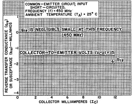
Fig. 8 - Reverse transadmittance ( $y_{re}$ ).
