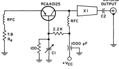
C1 : 0.4 - 6.0 pF, AIR-DIELECTRIC, PISTON-TUNED CAPACITOR
