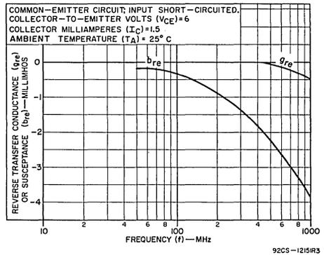
Fig. 12 - Reverse transmittance ( $y_{re}$ ).
