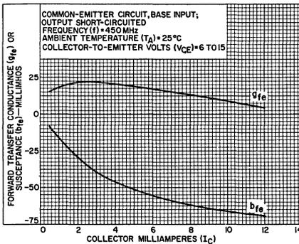
Fig. 7 - Forward transadmittance ( $y_{fe}$ ).
