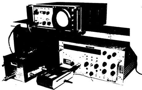
Fig. 11— The HP8410A Network Analyzer.
