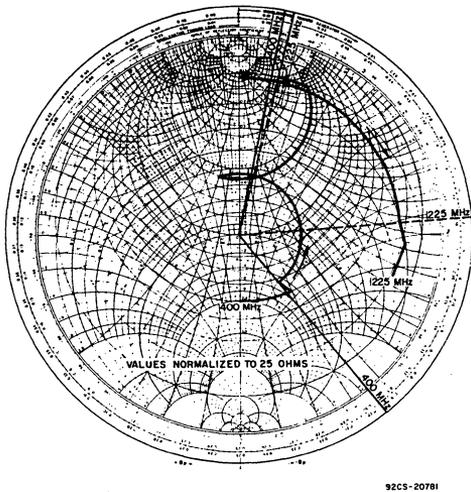
Fig 12— Input-circuit impedance/admittance chart.
