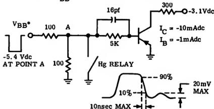
10mA TOTAL CONTROL CHARGE TEST CIRCUIT
