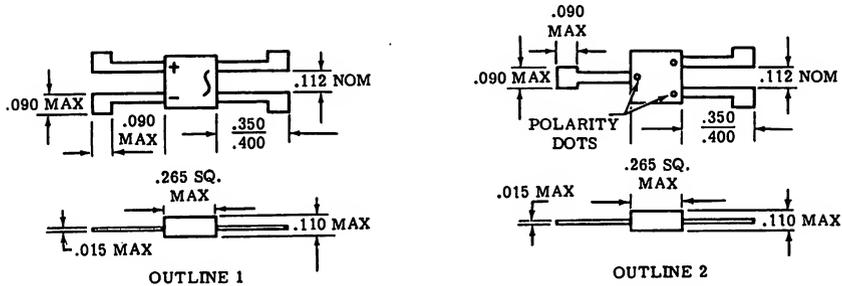
POLARITY DOTS: R; RED-POS. OUT
