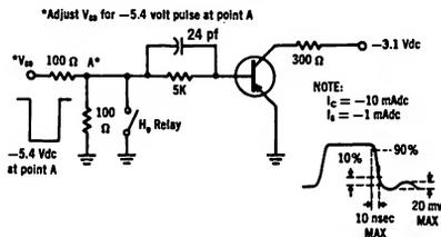
10-mA ( $I_C$ ) TOTAL CONTROL CHARGE TEST CIRCUIT
