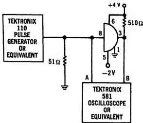
**PROPAGATION DELAY MEASUREMENT CIRCUIT**
