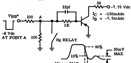
150mA TOTAL CONTROL CHARGE TEST CIRCUIT
