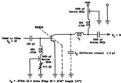
**250 MC POWER GAIN TEST CIRCUIT (MM1803)**
