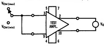
$\Delta V_{os}$  RECORDED FOR A CHANGE IN THE COMMON MODE INPUT BIAS FROM MAXIMUM TO MINIMUM VALUES.
