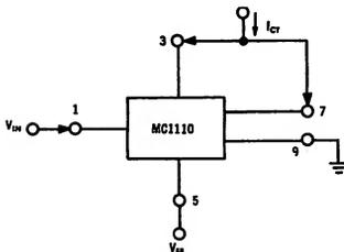
**SHORT CIRCUIT ADMITTANCE TEST CIRCUIT**
