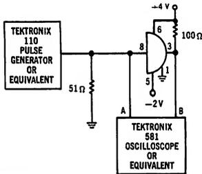
**PROPAGATION DELAY MEASUREMENT CIRCUIT**
