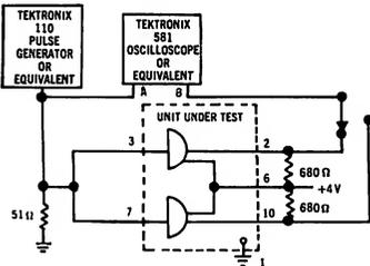
**PROPAGATION DELAY MEASUREMENT CIRCUIT**
