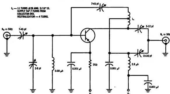
**FIGURE 2: 10MC POWER GAIN TEST CIRCUIT — 2N3324**
