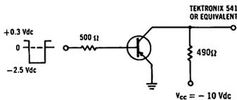
10-mA ( $I_C$ ) SWITCHING TIME TEST CIRCUIT
