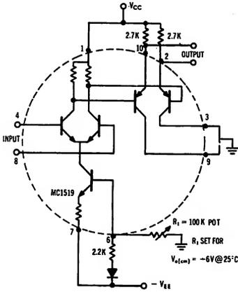
CIRCUIT A COMMON EMITTER OUTPUT
