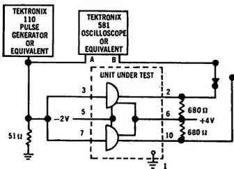
**PROPAGATION DELAY MEASUREMENT CIRCUIT**
