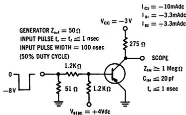
**SWITCHING TIME TEST CIRCUIT**
