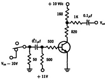
**TURN-ON AND TURN-OFF TIME TEST CIRCUIT**
