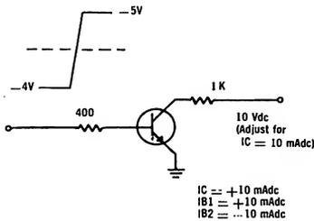
**CHARGE STORAGE TEST CIRCUIT**
