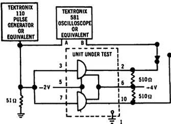
**PROPAGATION DELAY MEASUREMENT CIRCUIT**
