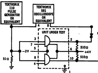
**PROPAGATION DELAY MEASUREMENT CIRCUIT**
