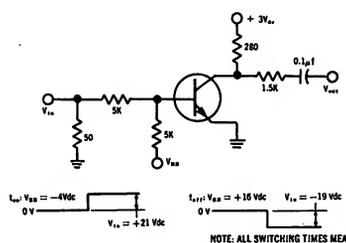
**CHARGE STORAGE TIME CONSTANT MEASUREMENT CIRCUIT**
