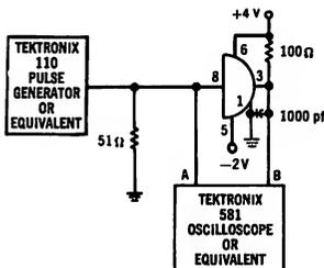
**PROPAGATION DELAY MEASUREMENT CIRCUIT**
