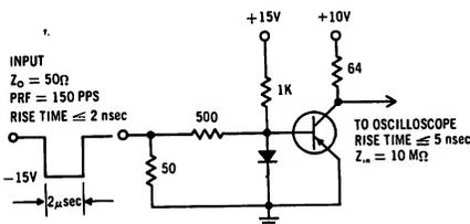
**STORAGE AND FALL TIME TEST CIRCUIT**
