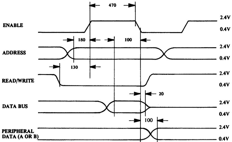
**\*NOTE: ALL TIMES SPECIFIED ARE IN nSEC FOR 1MHZ OPERATION.**
